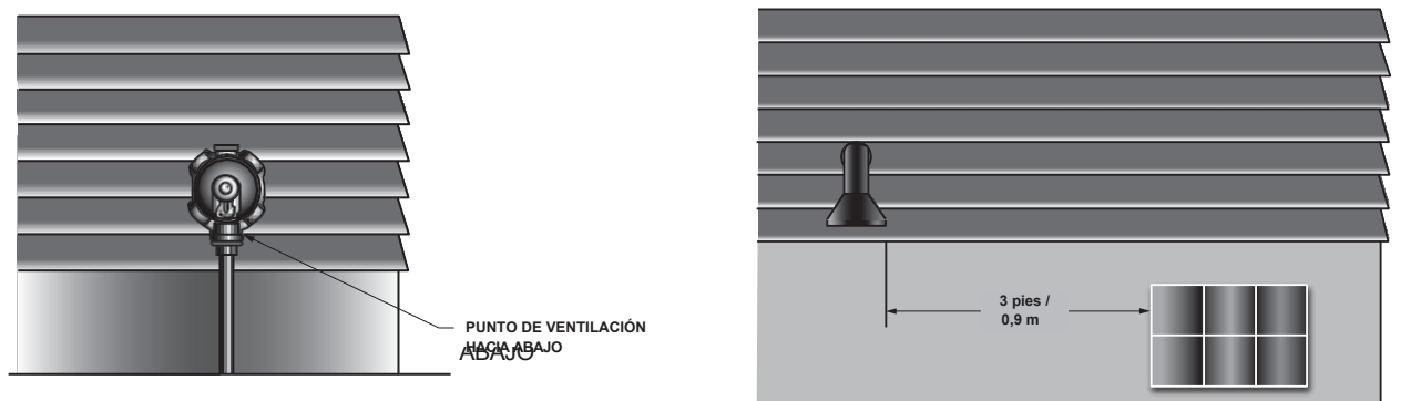
Figura 2. Regulador con ventilación apuntando hacia abajo
