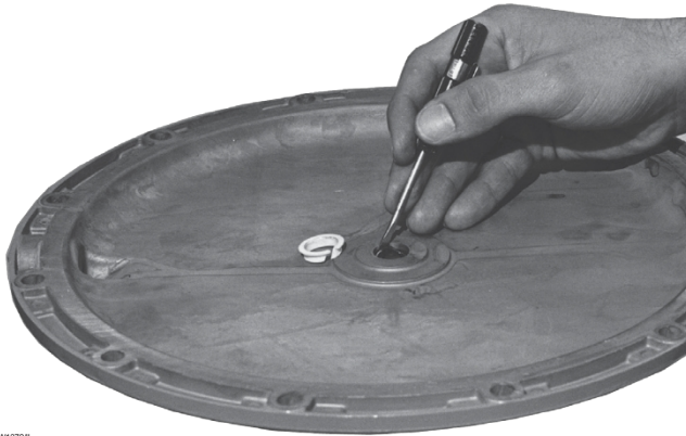
Figura 5. Inspección del casquillo guía y la junta tórica del sello del vástago
